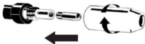
Установите обратно контактную трубку и сопло на горелку.
